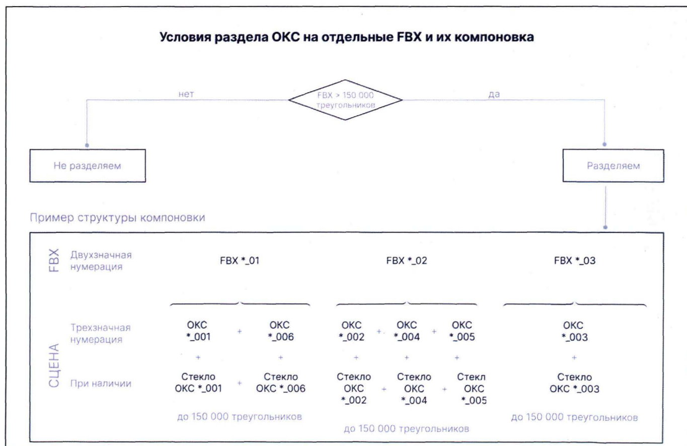
Рис. 3. Условия разделения и пример компоновки ОКС
